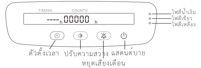
รูปที่ 4: แผงควบคุม
